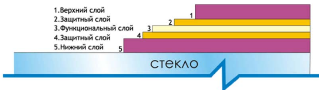
Рисунок 3 - Структура мультифункционального стекла
