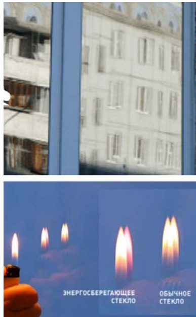
Рисунок 1 - Визуальные различия энергосберегающих стекол
